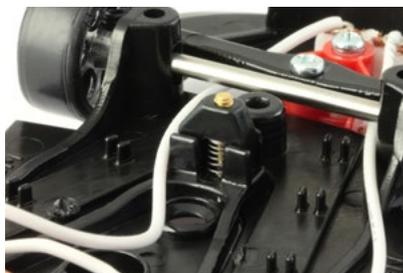
Per i più "smanettoni", è consigliato perfezionare la regolazione dopo aver seguito questa istruzione di base, provando poco per volta a svitare o avvitare le viti.
