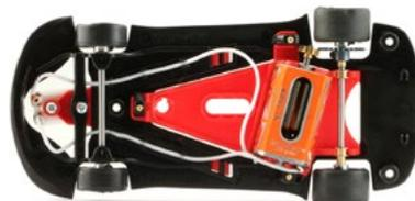
**Configurazione IL:** equipaggiata di motore KING (cassa lunga), garantisce un'ottima frenata, ottima velocità, ottima attrazione magnetica. Tuttavia, la configurazione IL presenta delle imperfezioni in termini di agilità nelle curve strette e di bilanciamento.
